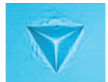
使用三棱锥压头产生的压痕
