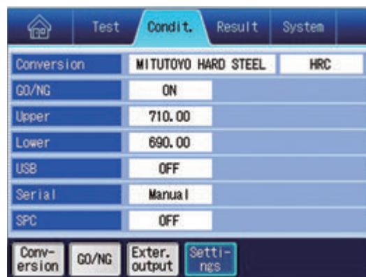
用于选择转换标尺、输入合格/不合格判定的设置并指定外部输出。
