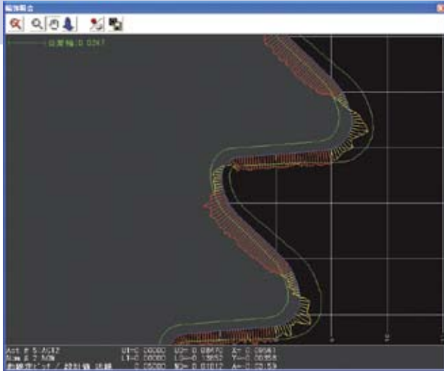
▲ 刃口的锯齿状态对比示例
