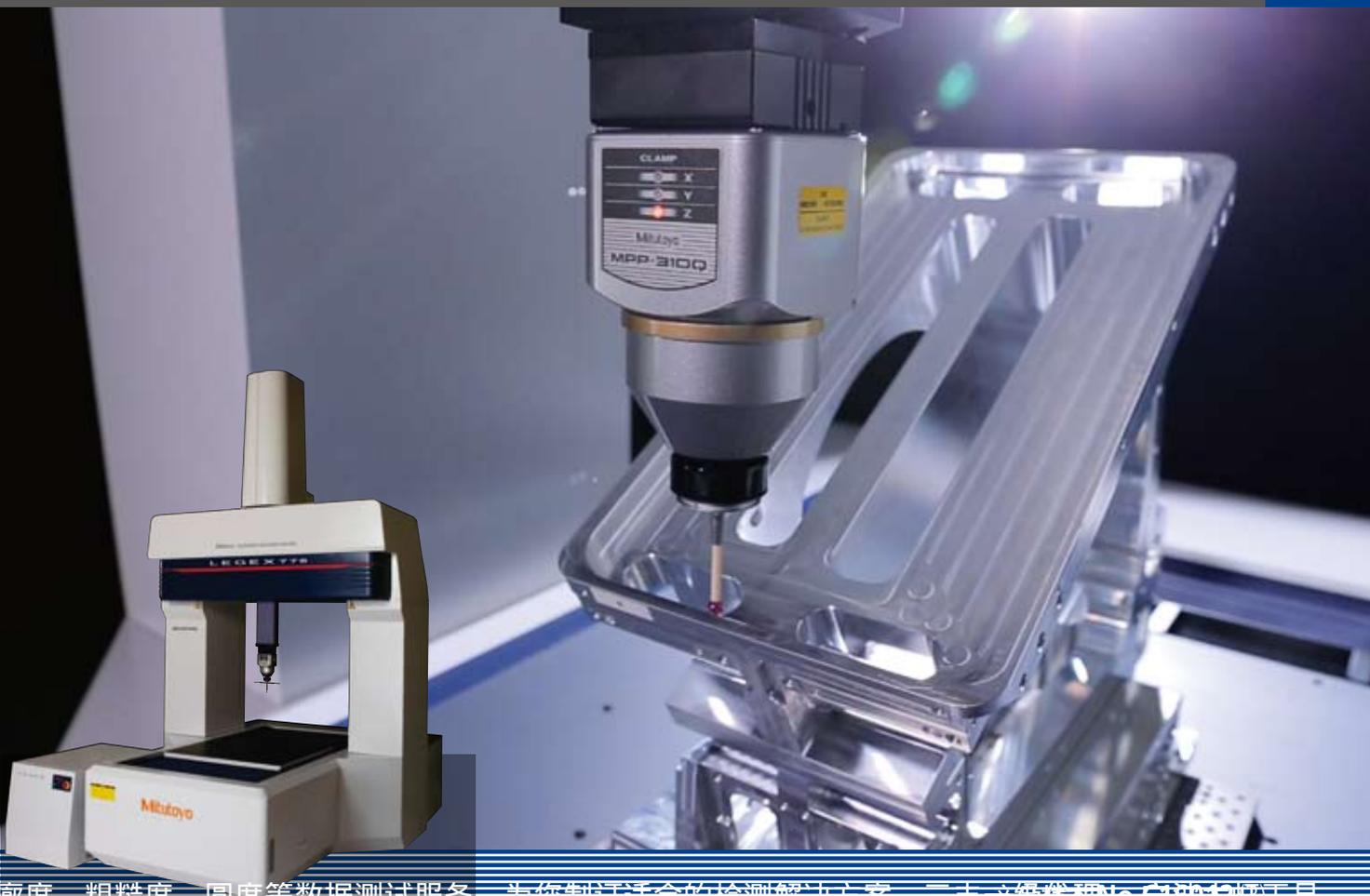
提供轮廓度、粗糙度、圆度等数据测试服务，为您制订适合的检测解决方案 - 三丰产线代理No. C100120工具
