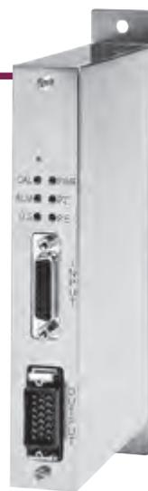
● PSU-200将本公司线性栅尺输出的正弦波信号分割为最少4份、\* 200份，并将其转换为方波信号并输出，这样NC反馈系统、测量控制装置等可与线性栅尺一起使用，以完成高精度定位。
