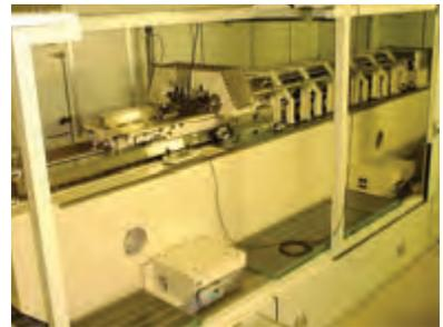
配备真空激光干涉的\* 精度测长机
