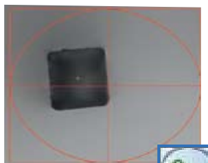
区域质心工具 重心位置检测工具。适 宜于异形物的定位。
