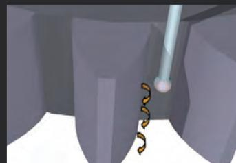
细微齿轮齿形 / 齿线测量
