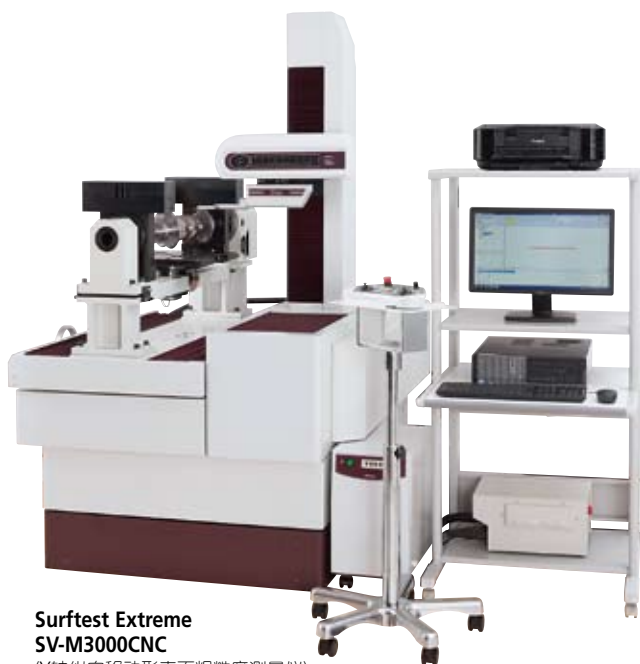
Surftest Extreme SV-3000CNC (驱动部倾斜结构+附带Y轴工作台)
