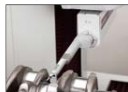
(测量实例)旋转型检出器 (检出器: 向后)
