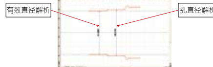
上、下测量方向通过软件切换
