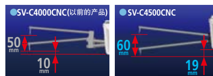
Z1轴测量范围增加了10mm (安装了单切面测针SPH-71时)
